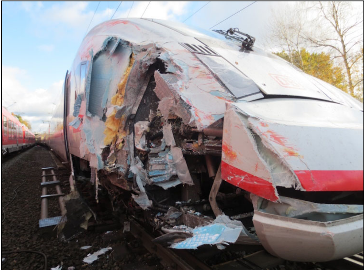
Abbildung 5: Beschädigungen im Frontbereich des Triebzuges des ICE 615
