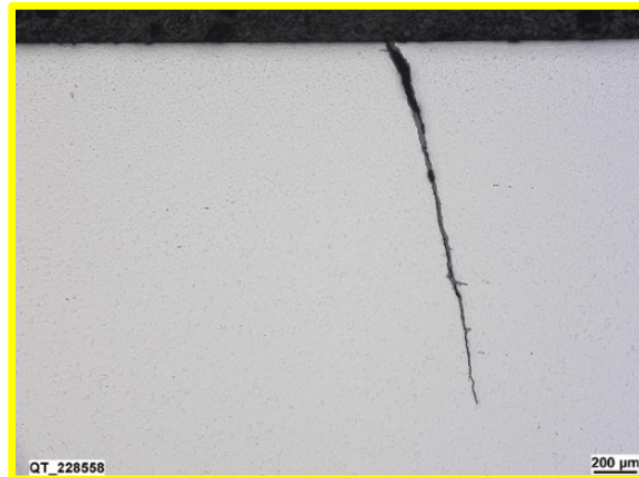
Abbildung 88: Intaktes Rad der Achse 3, mit senkrechtem Riss, ohne plastische Verformung. Details sind in der Anlage 6, Abbildung 100 aufgeführt.
