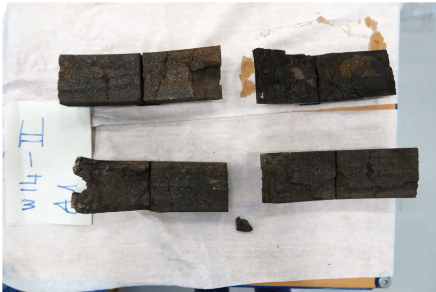
Abbildung 71: Bremssohlen der ersten Achse von Wagen 14-2.
