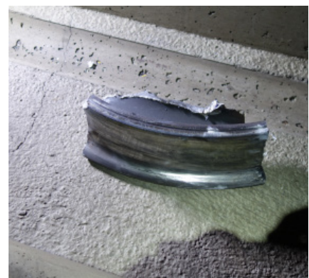
Abbildung 38: Abgebrochenes Radstück der Achse 1 des Wagens 11.
