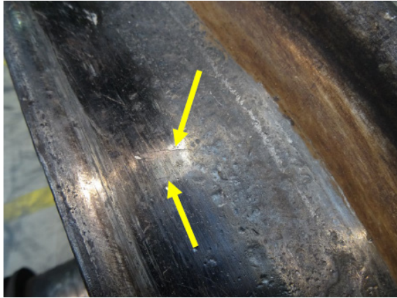
Abbildung 86: Visuelle Rissanzeichen an der Oberfläche.
