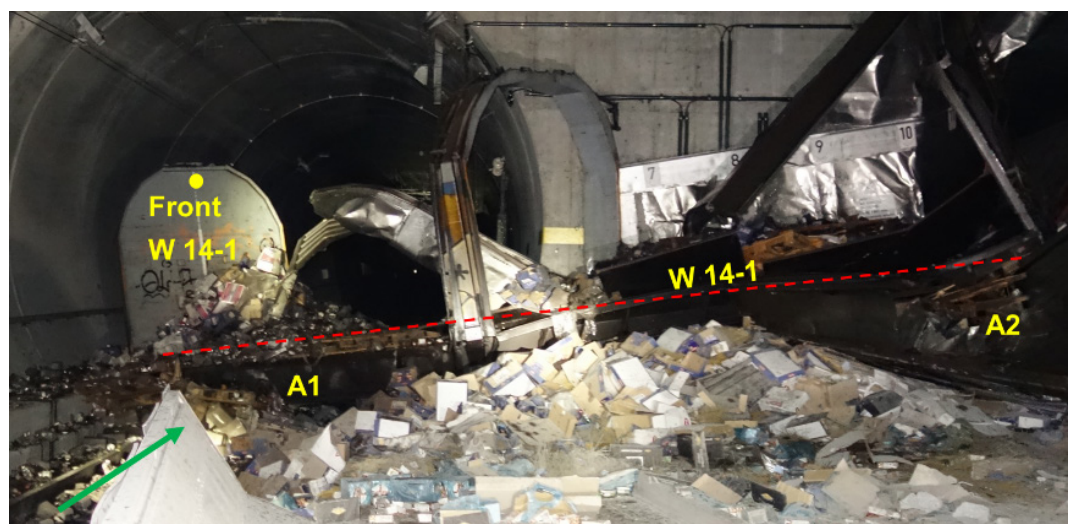
Abbildung 10: Detailaufnahme von Wagen 14-1. Anhand der rot gestrichelten Linie soll die Lage des Wagenbodens dargestellt werden.
