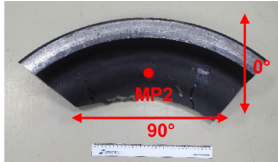
Abbildung 77: Eigenspannungsmessung am Radsteg im Messpunkt MP2.
