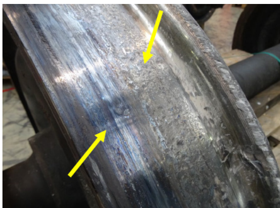
Abbildung 83: Blaue Verfärbung der Lauffläche. Gelbe Pfeile: Rissanzeichen.
