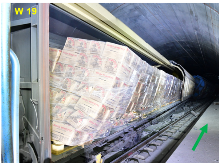
Abbildung 14: Wagen 19 (offene Schiebewand und Ladungsverschiebung als Folge des Aufpralls).
