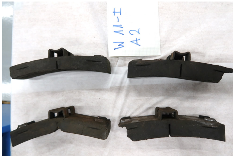
Abbildung 69: Bremssohlen des Radsatzes 2 von Wagen 11.
