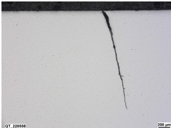
Abbildung 99: Lichtmikroskopische Aufnahme der intakten Lauffläche von Radsatz 3; Riss ausgehend von der Lauffläche, ungefähr senkrecht zur Oberfläche, ohne Ermüdung durch Überrollbeanspruchung .
