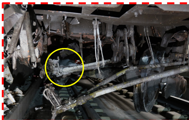
Abbildung 6: Detailaufnahme der Achse. Im gelben Kreis ist der Rest der gebrochenen Radscheibe sichtbar. Im Vordergrund ist das herunterhängende, in Fahrtrichtung vordere, Bremsdreieck erkennbar.
