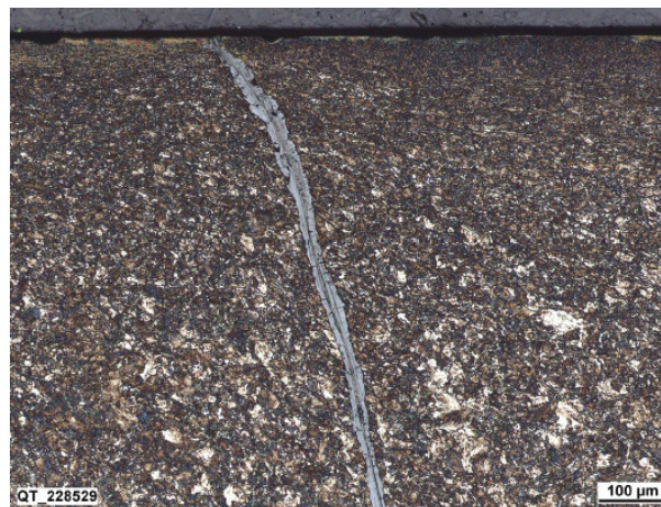
Abbildung 76: Mikroschliff, Risse mit Produkten gefüllt.
