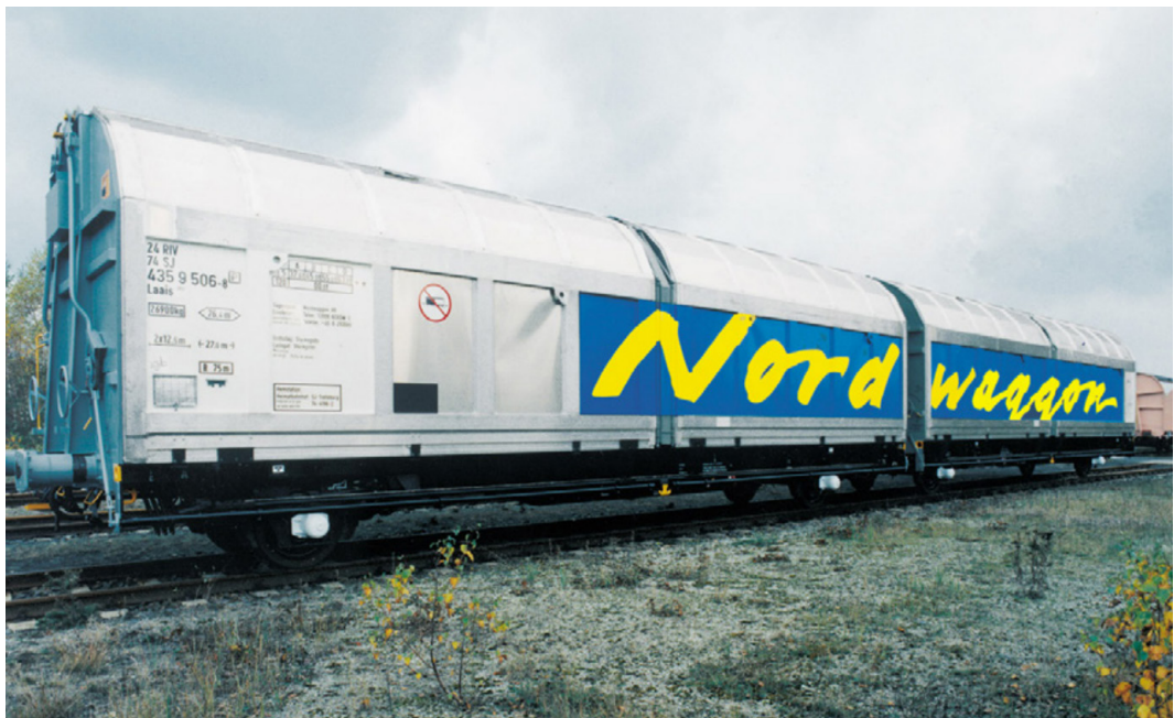
Abbildung 65: Wagentyp Laaiis – bauähnlich wie Wagen 11 (Quelle: TWA).
