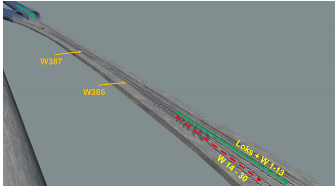
Abbildung 31: Graphische Darstellung der Multifunktionsstelle Faido mit der Situierung der Fahrzeuge nach dem Stillstand.
