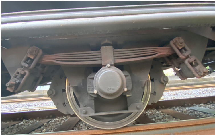
Abbildung 89: Mögliche Sicht auf eine Radscheibe eines Wagens vom Typ Laaiis. (Vergleichbare Aufnahme ausserhalb des Tunnels von Wagen 8 des Güterzuges 45016.)
