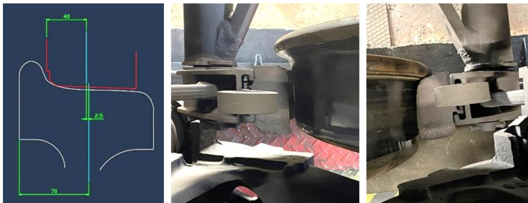
Figur 18 visar till vänster den teoretiska placeringen av ett bromsblock, i rött, mot hjulets löpyta i vitt. I mitten visas ett exempel på bromsblock som är placerat mot ytterkanten av hjulets löpyta. Till höger visas ett bromsblock som är placerat mot hjulflänsen. Källa: LKAB Malmtrafik AB.
