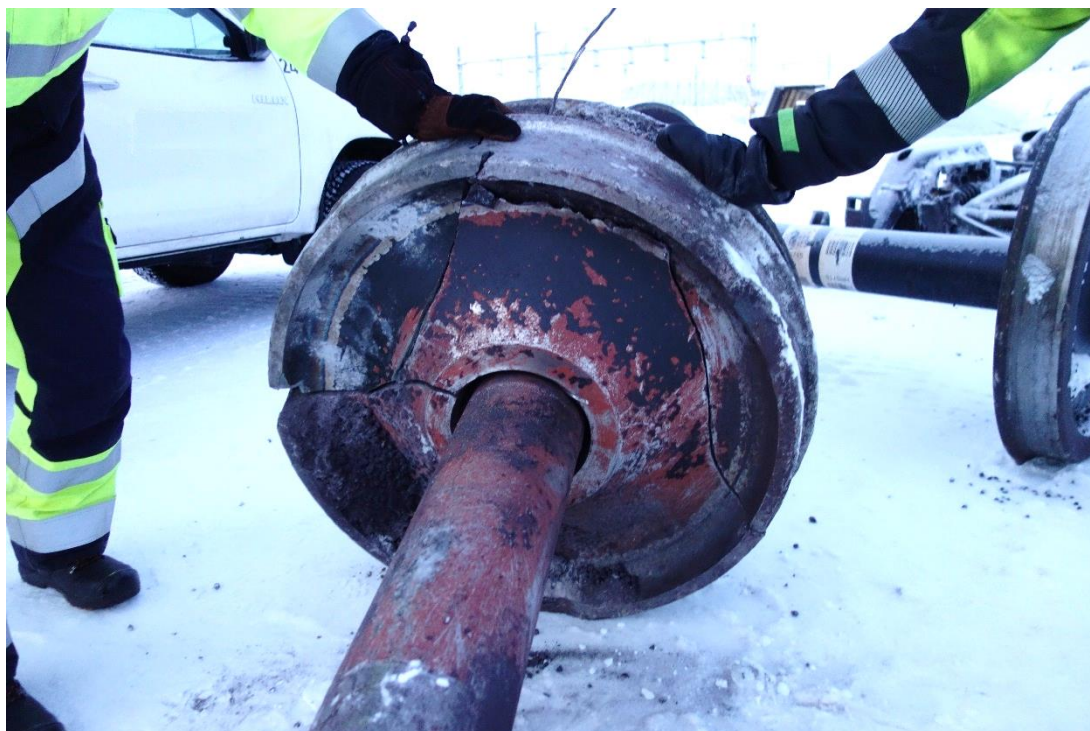
Figur 15 visar det skadade hjulet med de två lösa delarna inpassade. På vänster sida av hjulet framgår en spricka från löpbanan till navet.
