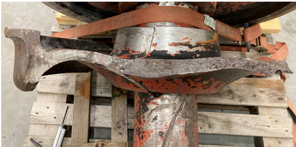
Figur 2. Det spruckna hjulet före nedmontering från axeln.
