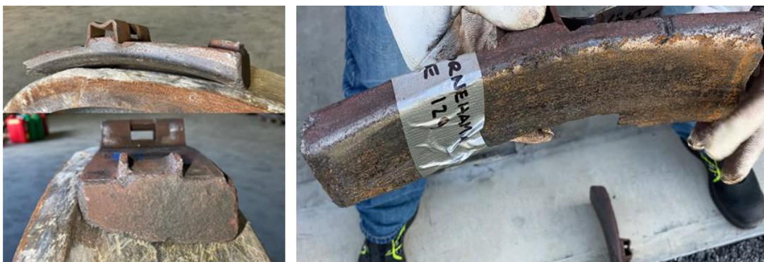
Figur 17 visar till vänster bromsblocket som hittades vid kontakledningsstolpe 117 med tydligt tecken på slitage på sidan mot en hjulfläns. Till höger visas bromsblocket från stolpe 129 utan motsvarande slitage på sidan som sitter mot hjulflänsen.
