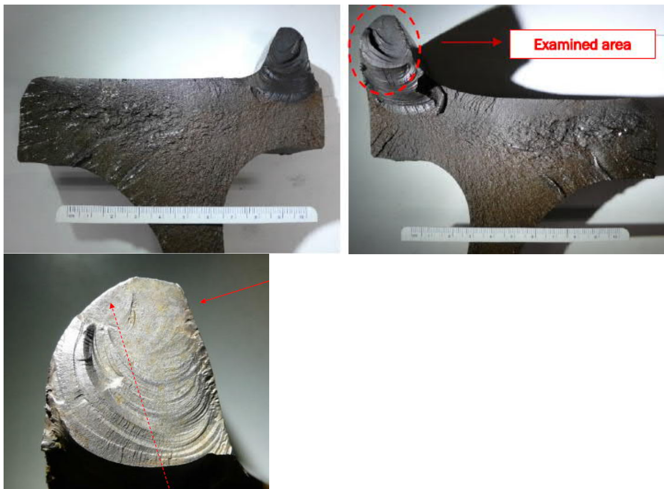
Figur 25. Brottyta från hjulet som sprack 2019, bilder från Lucchinis rapport MET 049_19 03/06/2019.
