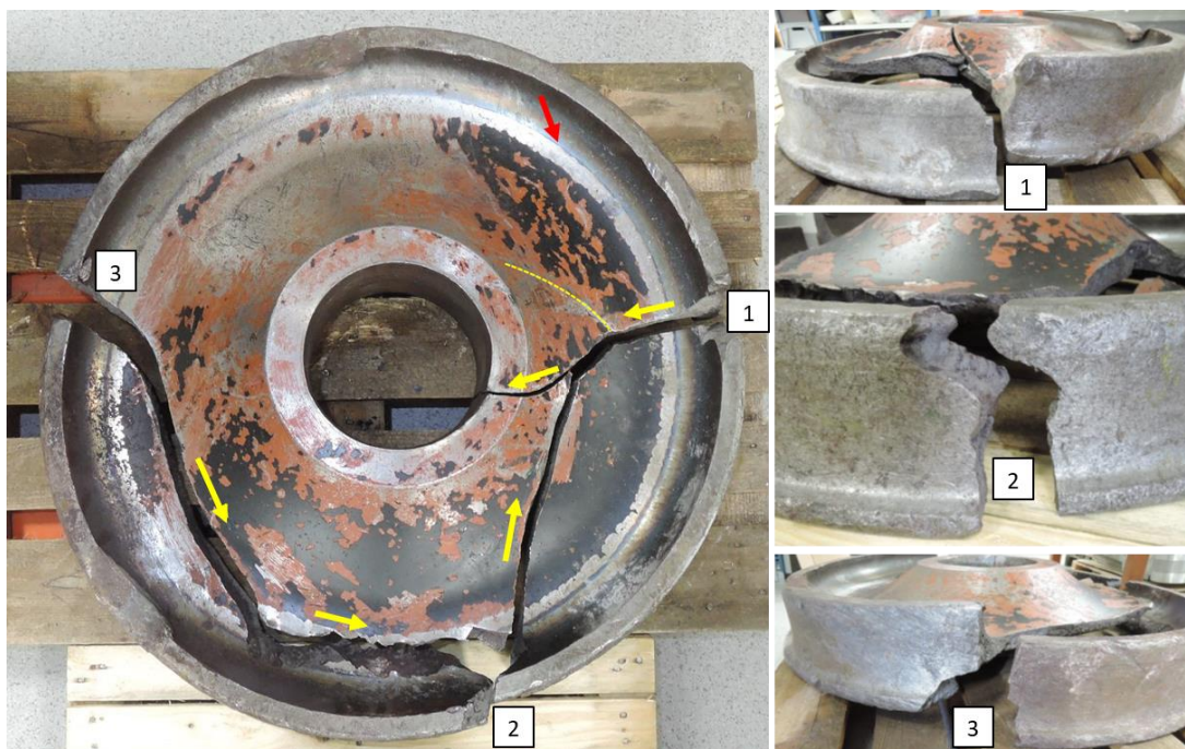
Figur 20 visar det skadade hjulet med brottytor markerade 1–3. Den blå färgskiftningen av värmeoxider framgår innanför hjulringen, markerad med en röd pil. De gula pilarna visar brottnens riktning enligt den fraktografiska undersökningen.
