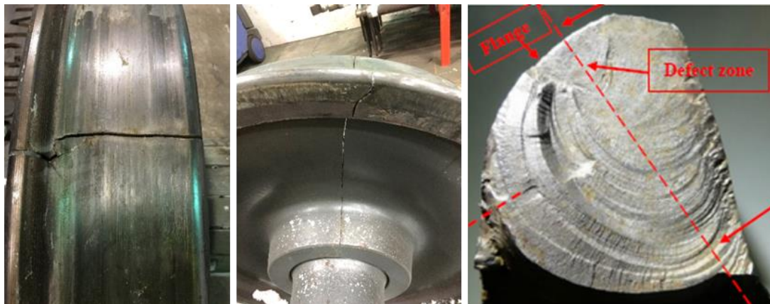
Figur 31 visar det spruckna hjulet från Narvik 2019 med sprickan i flänsen i detalj. Källa: LKAB Malmtrafik AB och Lucchini RS.
