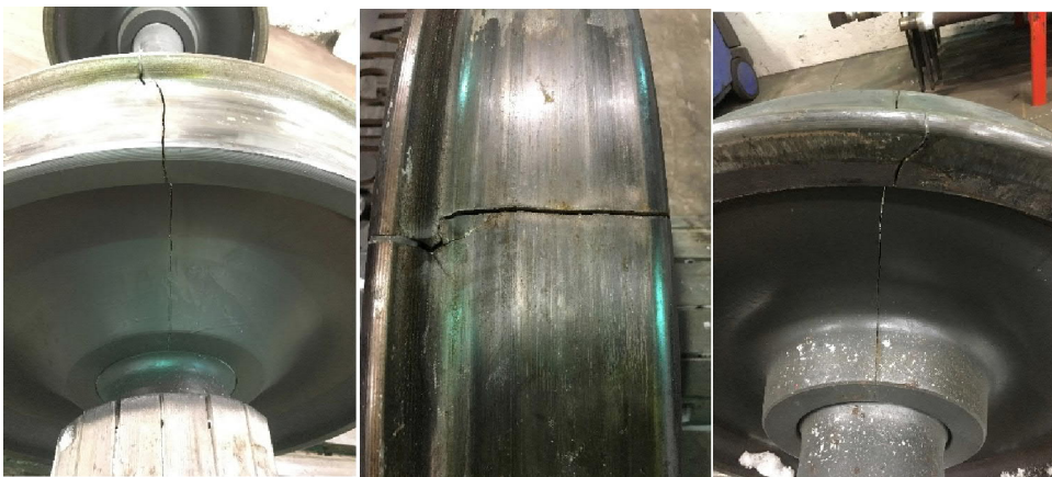
Figur 24. Hjulet som sprack 2019, bilder från LKABs rapport.
