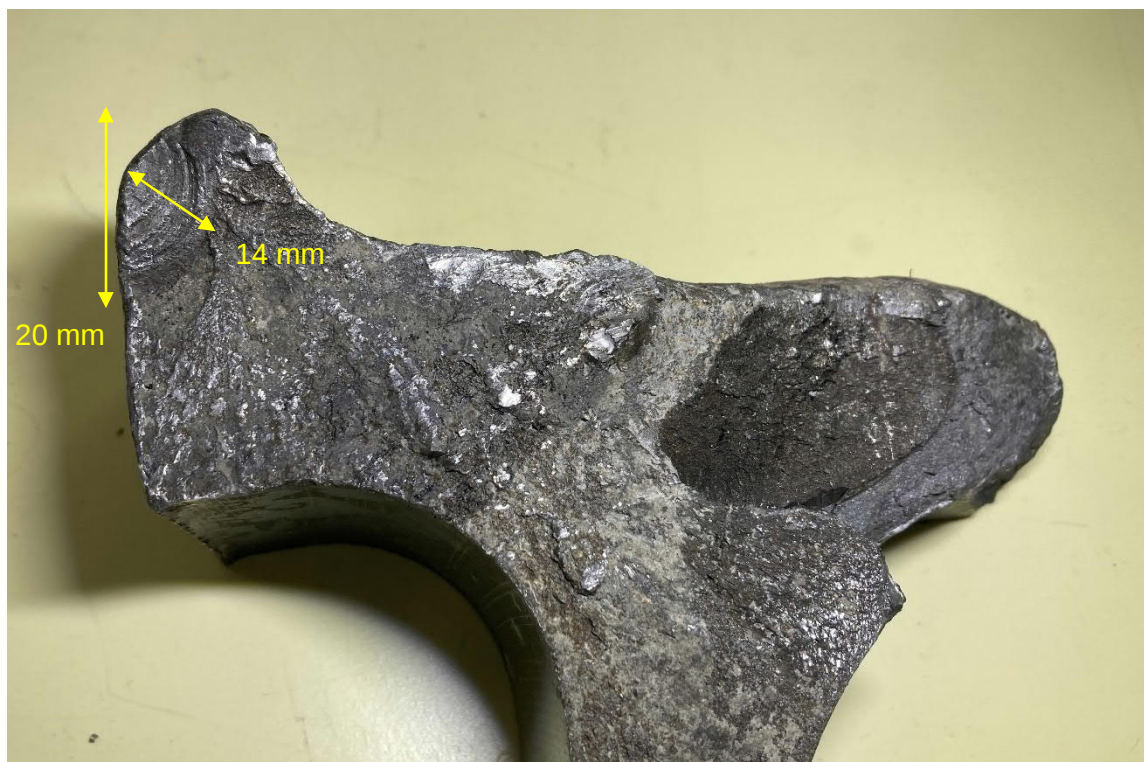
Figur 20. Brottyta vid position 1 (primärspricka) enligt Figur 3, färgvariationen är till följd av att det tagits replikor från de mörkare delarna.
