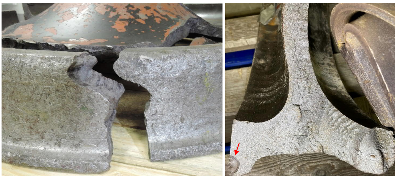
Figur 6. Brott genom löpbana, position 2 i Figur 3. En mindre utmattningsspricka noteras, se röd pil i höger bild, den bedöms vara sekundär.
