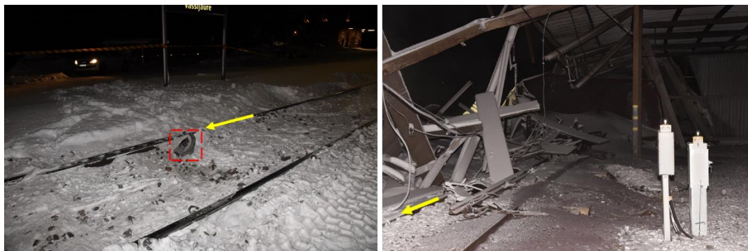
Figur 8 visar till vänster spår 1 med stationshuset och plattformen i bakgrunden. Mellan rälerna hittades en del av ett hjul, markerat med en röd streckad ruta. Till höger visas växeln från spår 1 och 2 mot Riksgränsen och det raserade snögalleriet. I bakgrunden ligger urspårade vagnar. Höger räl i färdriktningen är markerad med gula pilar.
