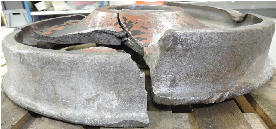
Figur 7. Brott genom löpbana, position 1 i Figur 3. En mindre bit saknas på utsidan av hjulringen.
