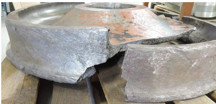
Figur 5 . Brott genom löpbana, position 3 i Figur 3. En mindre bit saknas på insidan (flänssidan) av hjulringen.
