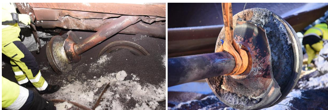
Figur 14 visar till vänster den skadade hjulaxeln under vagn 49 och till höger hjulaxeln när den kunde lyftas fram.
