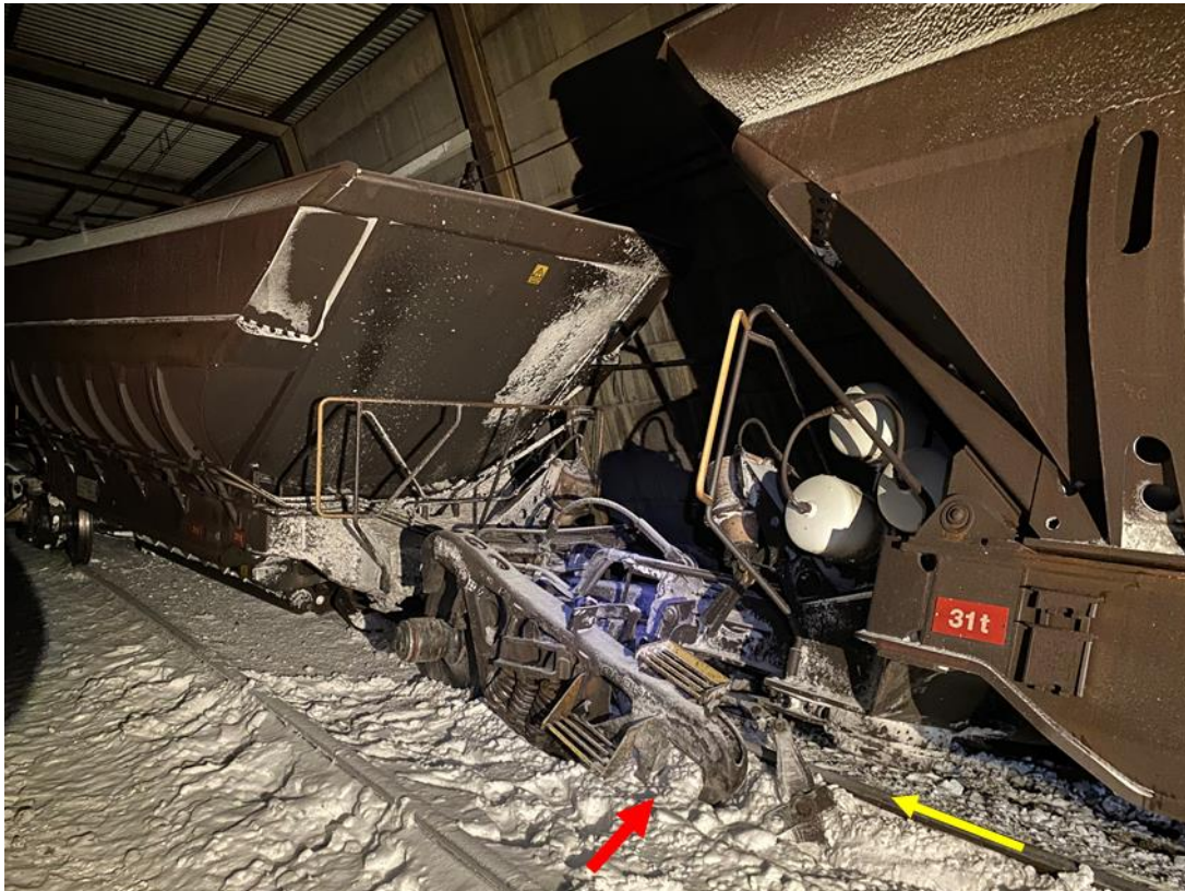
Figur 9 visar vagn 47 till vänster och den lossade boggien i mitten, som förskjutits bakåt mot vagn 48. Den röda pilen pekar mot platsen för den saknade hjulaxeln. Den högra rälen och tågets färdriktning är markerade med en gul pil.
