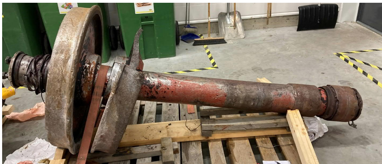
Figur 1. Det spruckna hjulet innan nedmontering från axeln, med det andra hjulet i hjulparet till vänster i bild.
