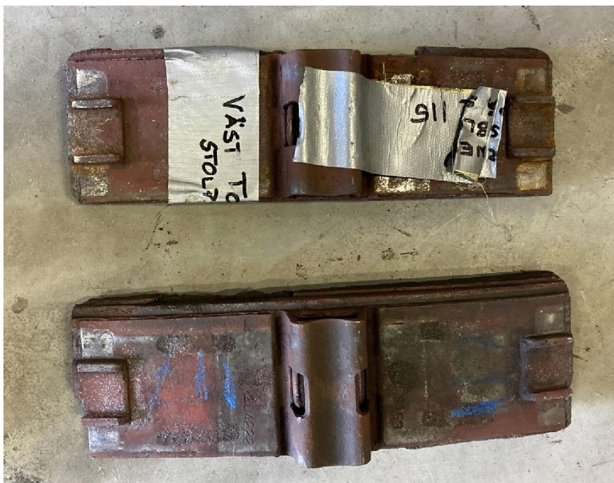
Figur 10. Bromsblock återfunna i samband med haveriet, någon gång under hanteringen har sannolikt märkningen/tejp (115) på det omärkta blocket lossnat och satts lite löst på det andra blocket.
