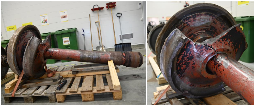
Figur 16 visar hjulaxel HP10380 vid den inledande undersökningen i SHK:s lokaler.
