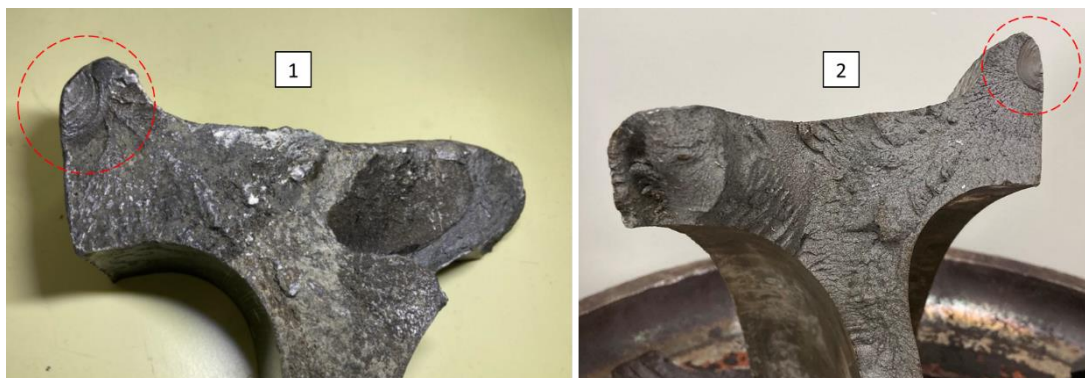
Figur 19 visar utmattningssprickorna i flänsarna vid brottytorna 1 och 2. Den mörka ovalen på brottyta 1 är spår efter avgjutning för tillverkning av replika (Struers Repliset) för kontroll i mikroskop.
