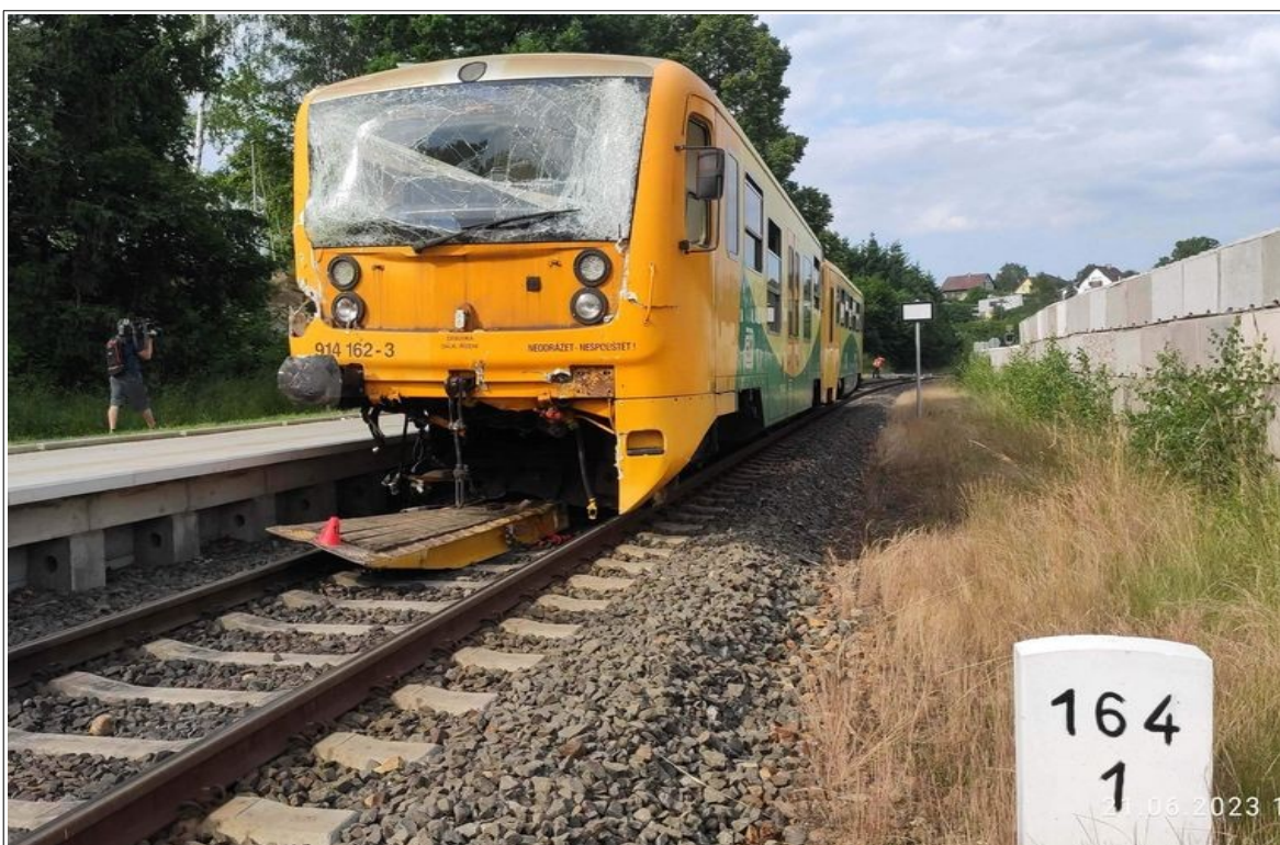
Obr. č. 4: Poloha zastavení a poškození vlaku Os 6385
