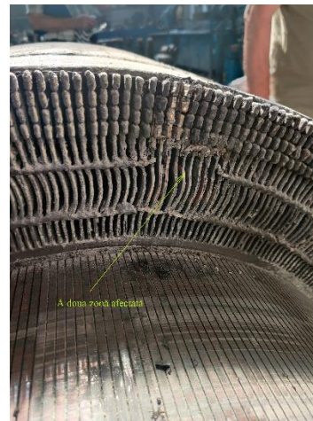
Foto nr.5 și nr.6 – cele două zone din rotor supraîncălzite (cu câte 12 stegulețe) cu cositorul topit la stegulețe și materialul electroizolant afectat termic
