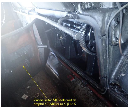
Foto nr.1 - Capacul carterului MD deformat
