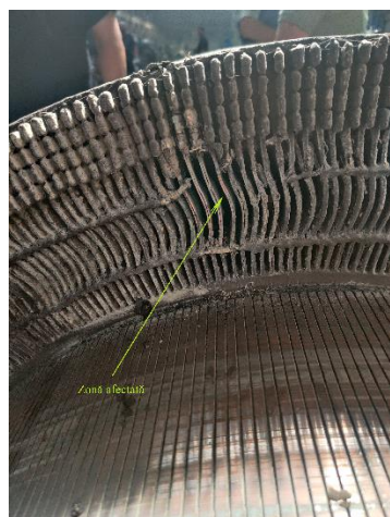
Foto nr.5 și nr.6 – cele două zone din rotor supraîncălzite (cu câte 12 stegulețe) cu cositorul topit la stegulețe și materialul electroizolant afectat termic
