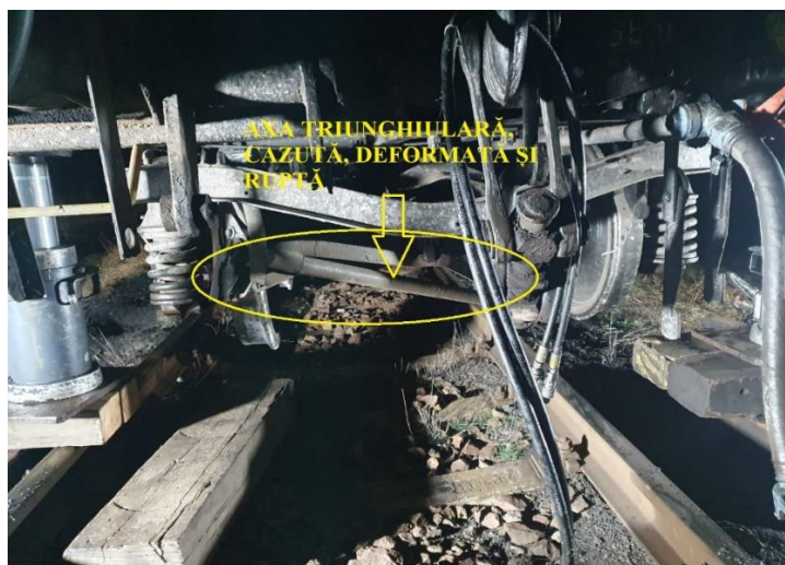
Foto nr.4 axa triunghiulară, aferentă părții din față a roții R2, era puternic deformată având axa centrală (cilindrică) ruptă nou 100%
