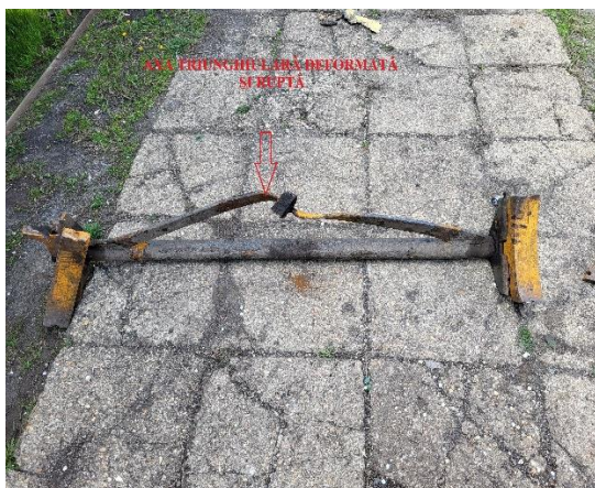
Foto nr.11 axa triunghiulară deformată
