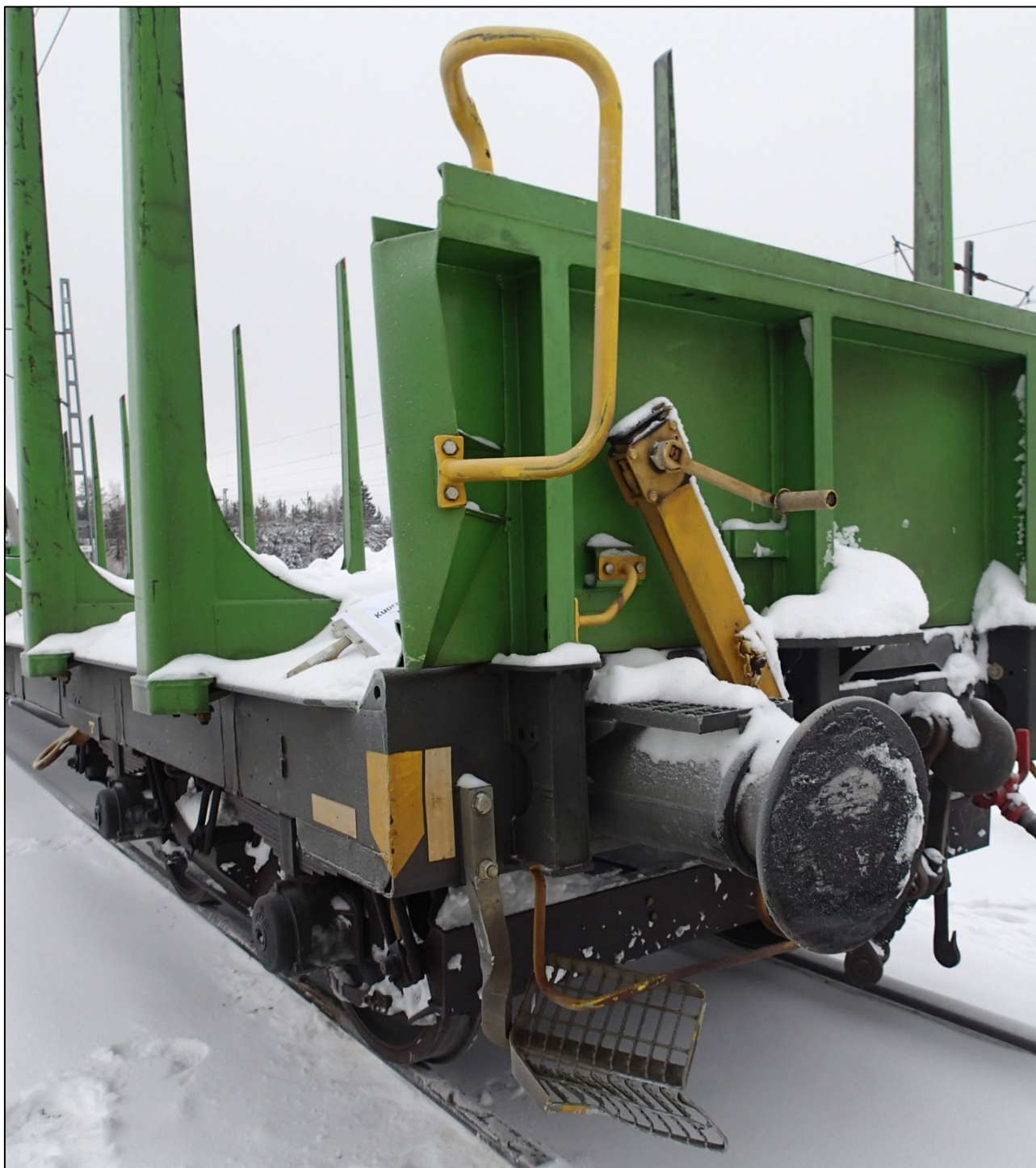
Kuva 9. Onnettomuudessa vaurioitunut raakapuuvaunun pääty. Astin, jolla vaihtotyönjohtaja seisoi, vääntyi törmäyksessä osin vaunun alle.
