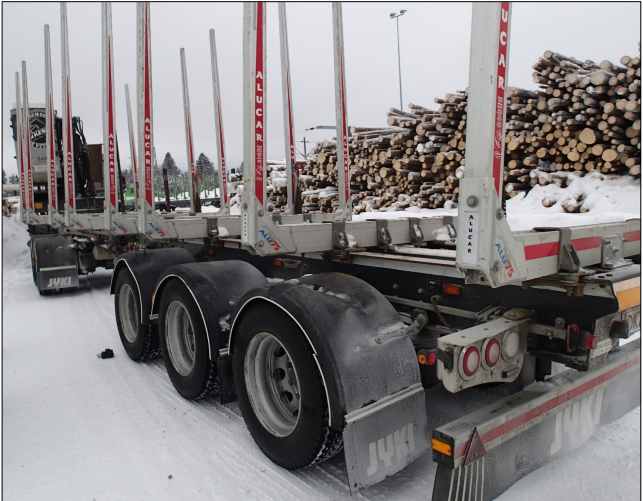
Kuva 8. Perävaunun takateli, johon vaihtotyöyksikkö törmäsi. (Kuva: OTKES)
