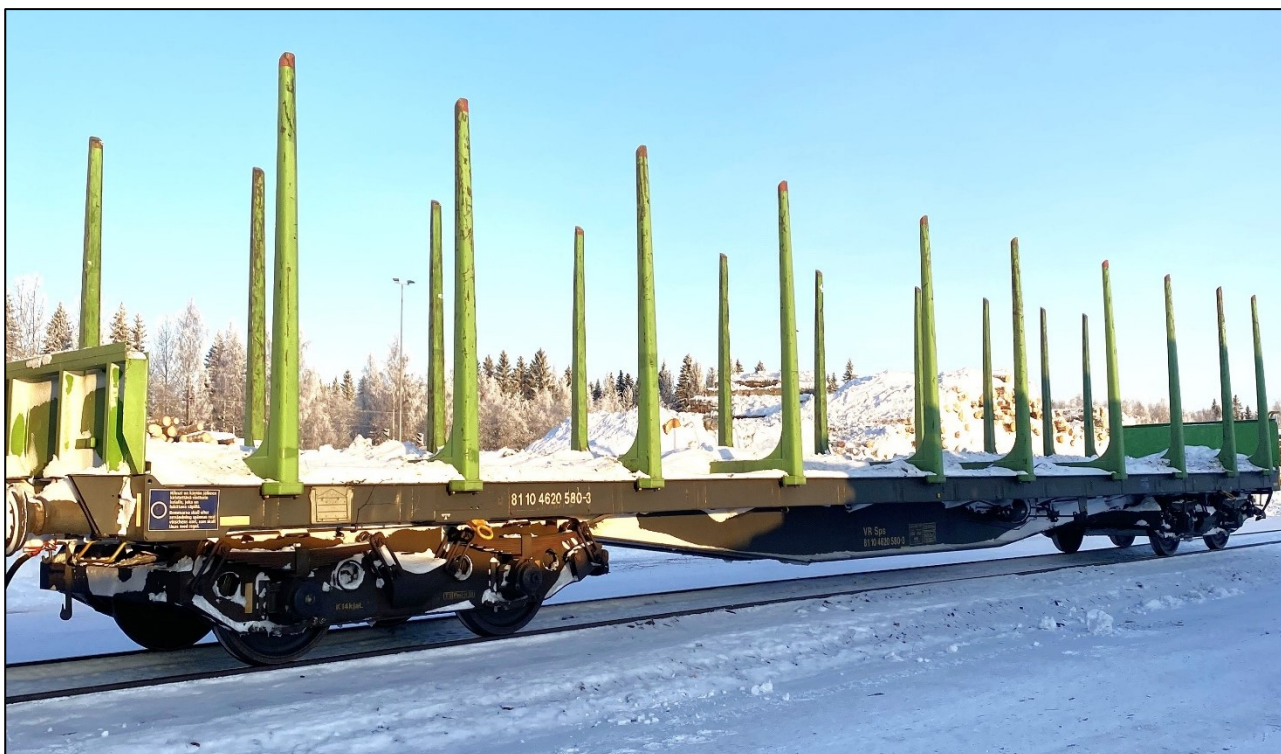
Kuva 12. Sp-sarjan raakapuuvaunu. (Kuva: OTKES)
